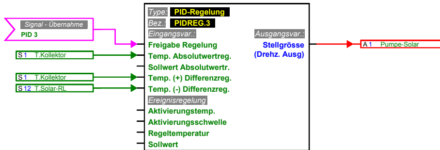
Ladefunktion Puffer Strahlung < 800W/m²
