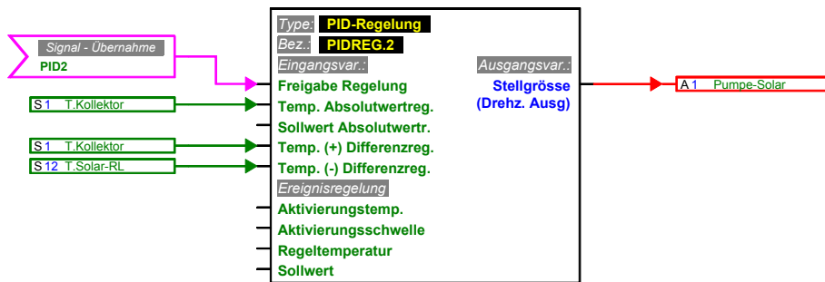
Ladefunktion Puffer Strahlung > 800W/m²
